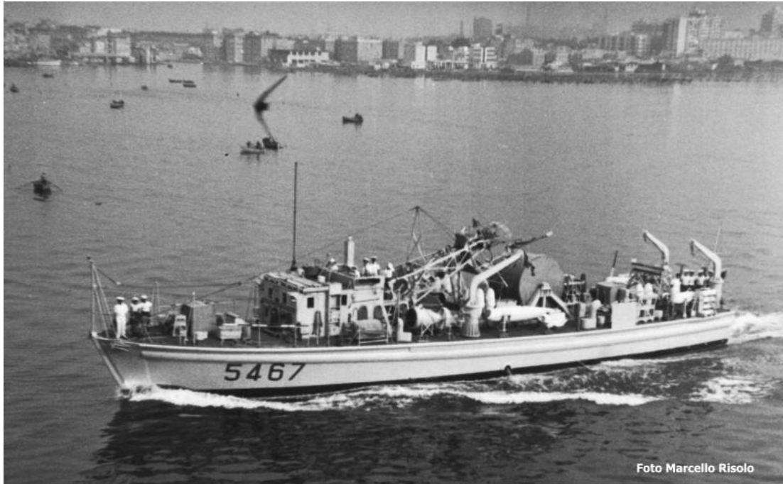
Il dragamine litoraneo Seppia 5467 , il 3 giugno 1967, mentre sta per imbocare il canale navigabile di Taranto. Per evitare l'apertura del ponte girevole, l'unità era stata dotata di un ingegnoso sistema, che per mezzo di un verricello, permetteva di piegare l'albero verso poppa.
